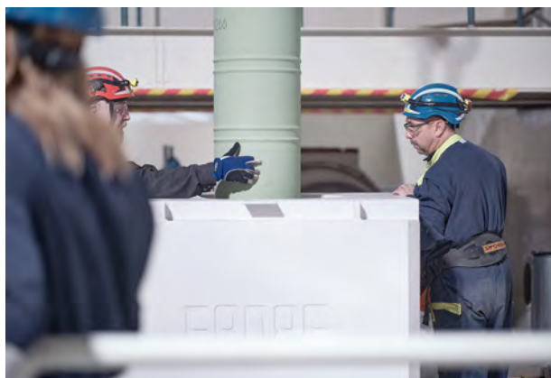
Staven klipps i kortare delar och placeras sedan i strålsäkra behållare inför transport och förvaring.
